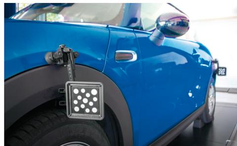
Keine manuelle Dateneingabe, schnellere Vermessung und höhere Genauigkeit dank unserer optionalen Targets zur Fahrzeugniveaumessung (TIP).
